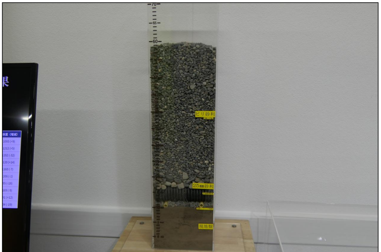
Aufbau des Geläufs, oben ist eine Schicht Kies von 5...15 mm Korngröße.
